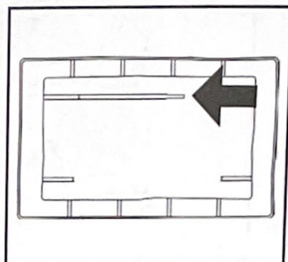
3. Вставьте направляющие через планки в нижней части крепления манежа, прежде чем соединять направляющие манежа друг с другом.
